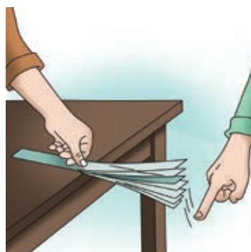
▲ 图2-5-1 钢尺的振动逐渐变弱
