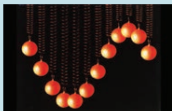
▲ 图2-1-9 弹簧振子运动的频闪照片
