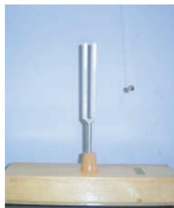
▲ 图2-1-5 音叉叉股的振动可以看作简谐运动
