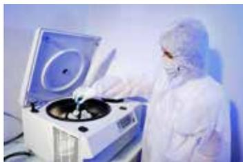
图2-4-12 用超速离心机提取DNA分子
