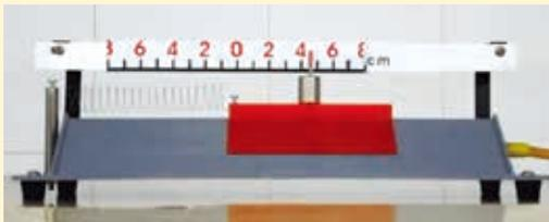
图4-1-7 滑块沿水平方向做往复运动
