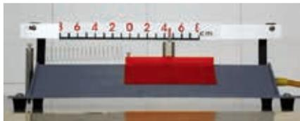
图4-5-6 滑块沿水平方向做往复运动
