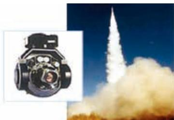
图2-4-11 运载火箭中的陀螺仪
