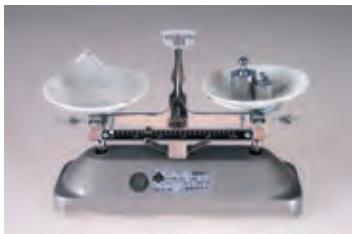
▲ 附图 如果砝码破损或受到污物沾染，利用天平称量物体的质量时，将会产生系统误差
