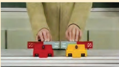
(c) 将两辆小车置于光滑导轨上，车上各固定一块条形磁铁，使两磁铁的同名磁极相对。用手控制两小车，使之靠近并静止，然后同时松开双手，两小车同时向相反方向运动。
