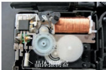
图4.1-4 石英电子钟里的晶体振荡器
