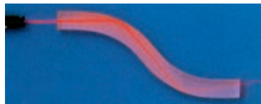
图 4.2-6 弯曲的有机玻璃棒能导光
