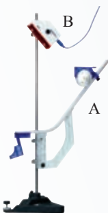
图 5.3-5 用传感器研究平抛运动的装置
