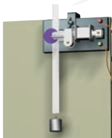
图2.4-2 自由落体运动的实验装置
