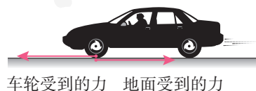
图3.3-5 汽车受驱动力的示意图
