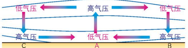
④ 只要A、B、C三地的温差维持，②和③中空气的垂直、水平运动就存在，从而形成热力环流。
