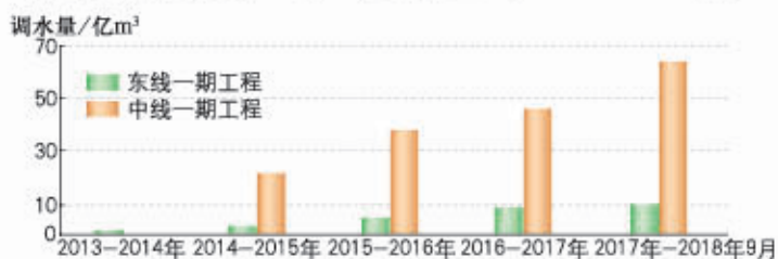
南水北调东中线一期工程调水量 (2013—2018 年)
