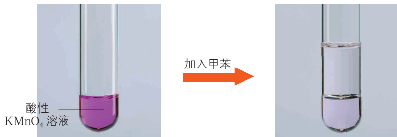
图1-3-8 甲苯与酸性 \text{KMnO}_4 溶液的反应
