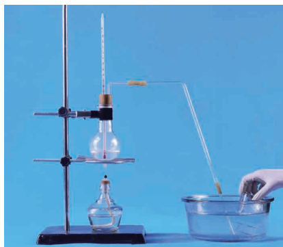
图2-1-3 实验室制备乙烯
