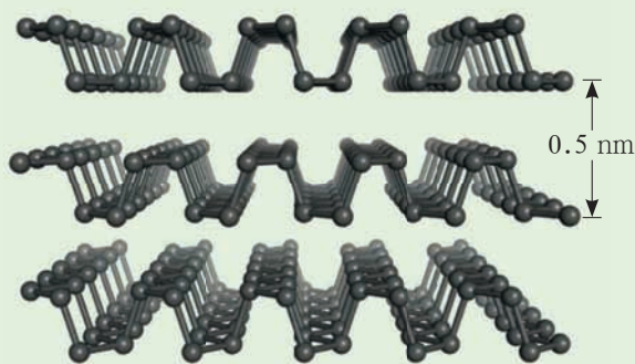
图3-2-17 正交晶型黑磷的微观结构
