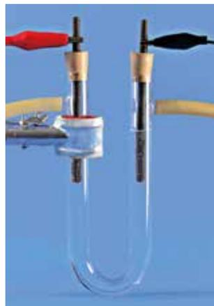
图1-3-3 实验室电解饱和食盐水装置图
