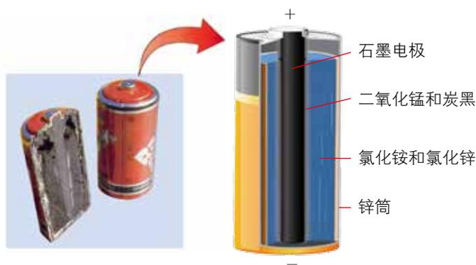
图1-2-5 酸性锌锰干电池及其结构示意图
