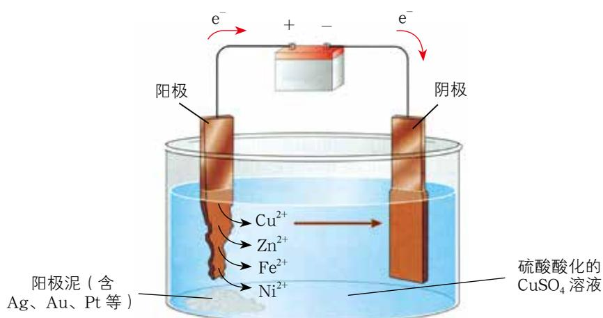
图1-3-5 铜的电解精炼示意图
