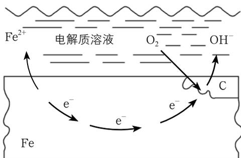
图1-4-3 钢铁吸氧腐蚀原理示意图
