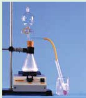
图3-5-1 模拟索尔维法的实验装置
