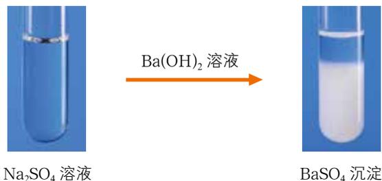
图3-4-2  $\text{Ba}^{2+}$ 与 $\text{SO}_4^{2-}$ 反应生成 $\text{BaSO}_4$ 白色沉淀
