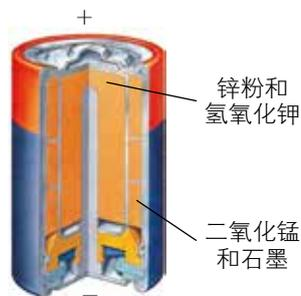
图1-2-6 碱性锌锰干电池结构示意图
