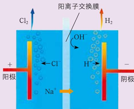
图1-3-4 离子膜法电解食盐水的原理示意图
