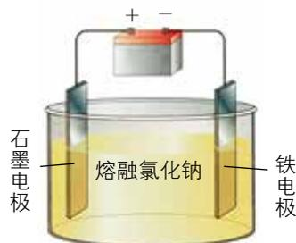
图1-3-2 电解熔融氯化钠的装置示意图
