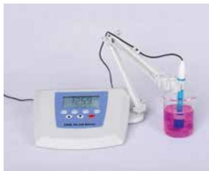
图3-1-4 用于精确测量溶液pH的酸度计
