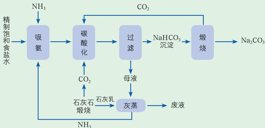
图3-5-4 索尔维法的基本工艺流程
