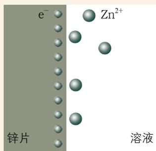
图 1-2-4 锌片与溶液之间电荷分布示意图
