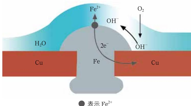
图1-4-2 铜板上铁铆钉处的腐蚀原理示意图
