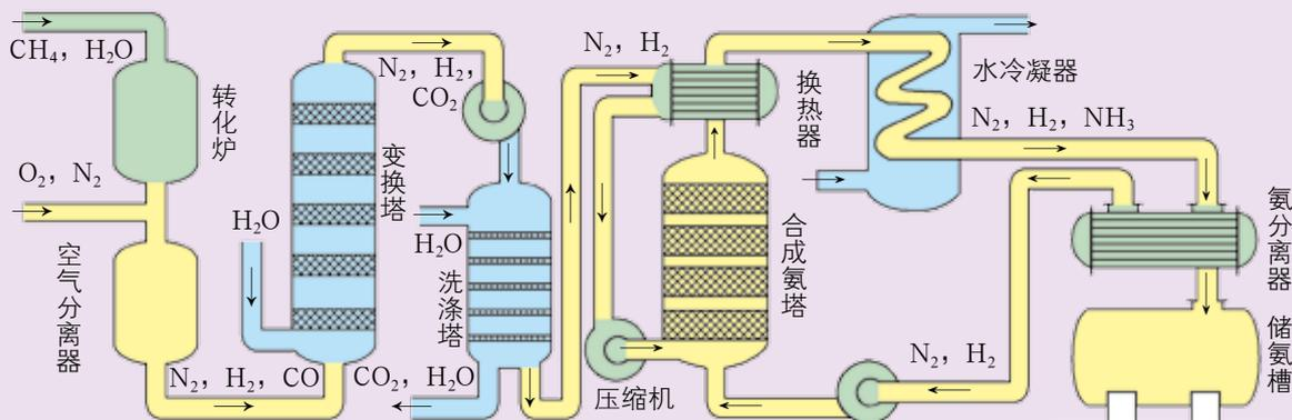
图2-4-4 合成氨工业生产流程示意图
