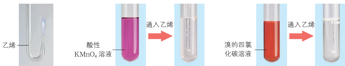
图3-2-8 探究乙烯化学性质的实验
