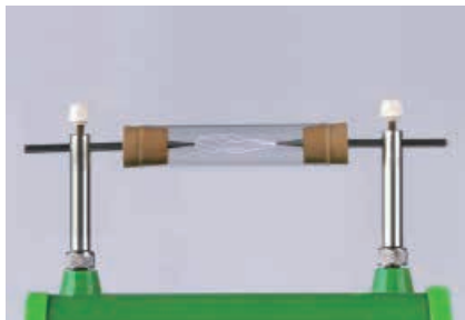
图 3-3-5 在放电条件下氮气与氧气发生反应
