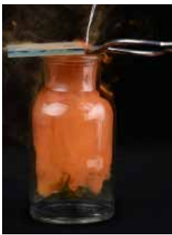
图 1-2-9 铁丝在氯气中燃烧
