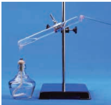
图 3-3-16 氯化铵固体与 NaOH 溶液的反应
