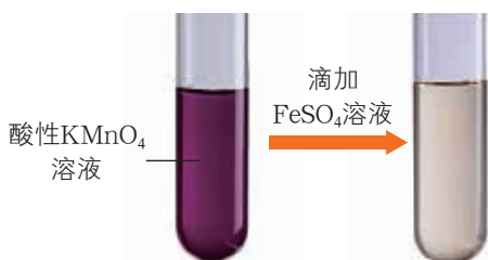
图 3-1-5 \text{FeSO}_4 溶液与酸性 \text{KMnO}_4 溶液的反应
