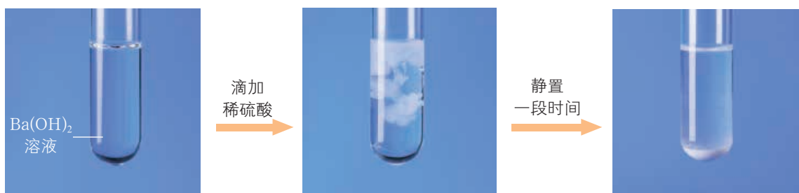
图 2-2-9 稀硫酸与 \text{Ba}(\text{OH})_2 溶液的反应
