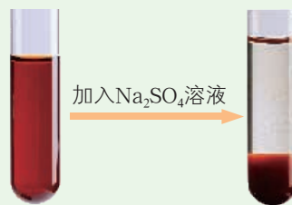
图 2-1-10 氢氧化铁胶体的聚沉
