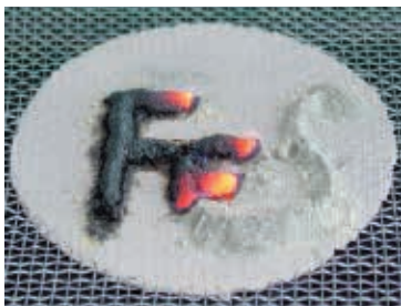
图 3-2-5 硫粉与铁粉的反应
