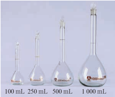
图 1-3-5 几种常用规格的容量瓶
