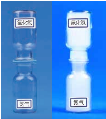
图 3-3-14 氨与氯化氢的反应
