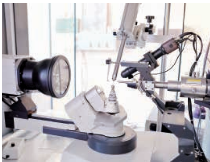
图 1-1-10 X射线衍射仪
