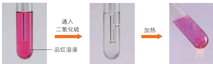
图 3-2-9 二氧化硫使品红溶液褪色
