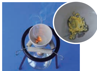
图 1-2-5 在空气中加热金属钠所发生的变化
