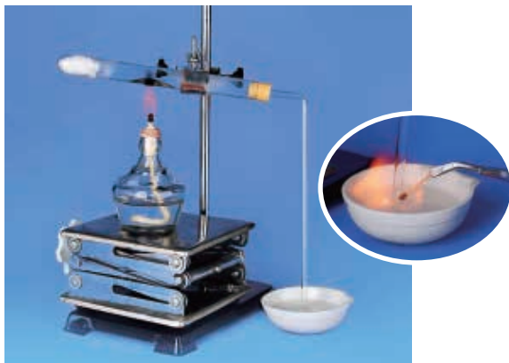
图 3-1-6 铁单质与水蒸气的反应
