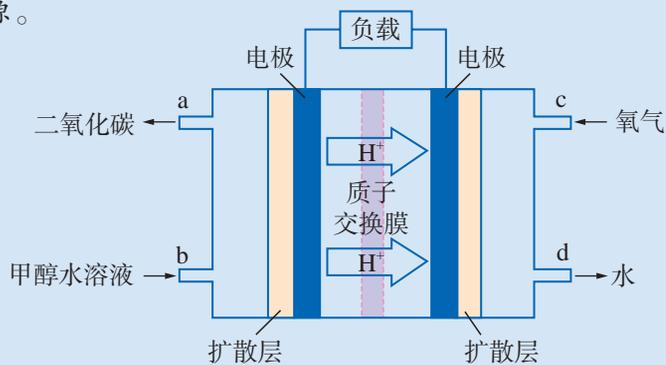
图 4-5 甲醇燃料电池的工作原理
