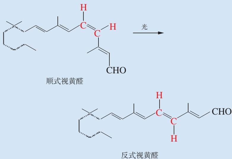
图 2-8 顺式、反式视黄醛的结构简式
