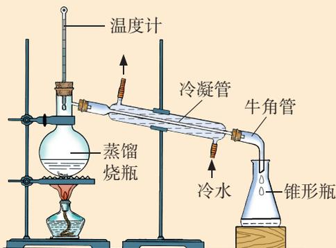
图 1-8 实验室蒸馏石油的实验装置
