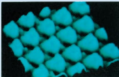
扫描隧道显微镜观察到的苯分子
