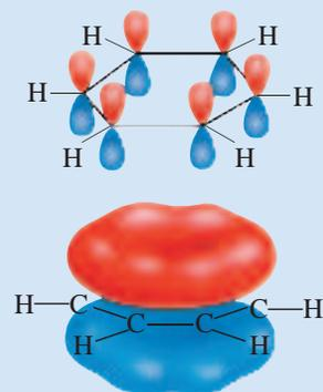
图 3-12 苯分子结构示意图
