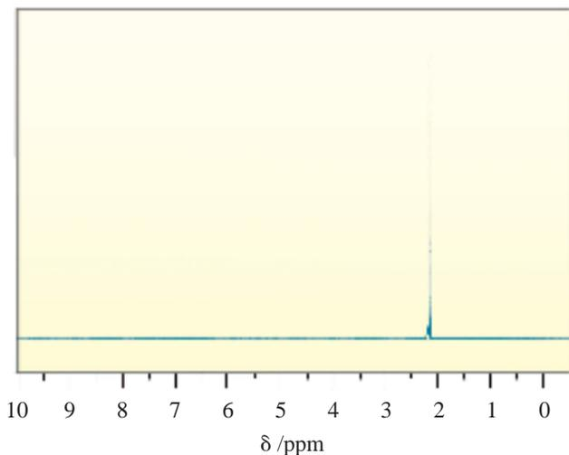
图 4-27 丙酮的<sup>1</sup>H核磁共振谱图
