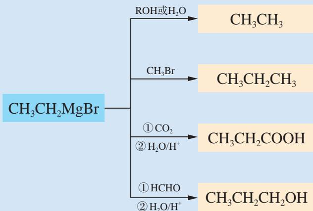
图 5-3 格式试剂在有机合成中的应用
