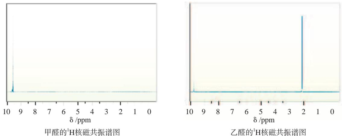
图 4-18 甲醛和乙醛的<sup>1</sup>H核磁共振谱图
