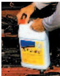
图 4-7 乙二醇作汽车发动机的抗冻剂
