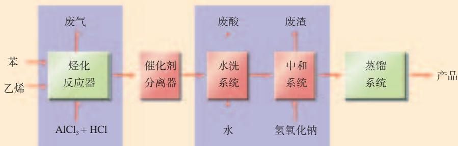
图 3-17  $\text{AlCl}_3$ 催化合成乙苯的工艺
