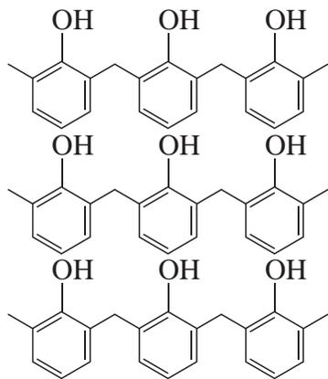
图 4-21 线型酚醛树脂的结构简式片段
