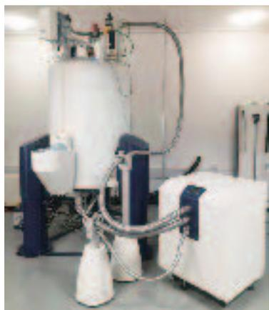
图 1-13 核磁共振仪
