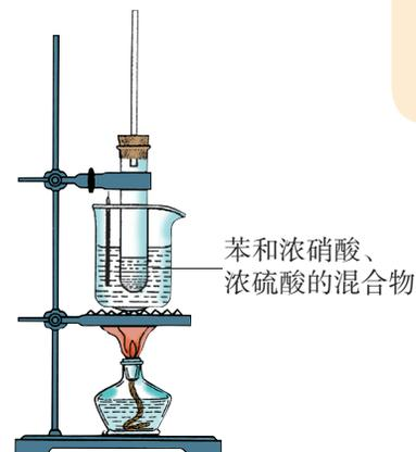
图 3-14 苯的硝化实验装置
