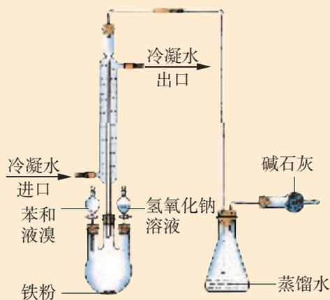
图 3-13 苯的溴化实验装置
