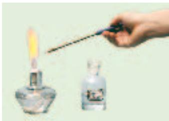
取一根铂丝（或细铁丝），放在酒精灯（或煤气灯）火焰上灼烧至无色。用铂丝蘸取少量KCl溶液，置于火焰上灼烧，透过蓝色钴玻璃观察火焰颜色。再用稀盐酸洗净铂丝，并在火焰上灼烧至无色，蘸取少量NaCl溶液，重复以上实验，观察实验现象。
