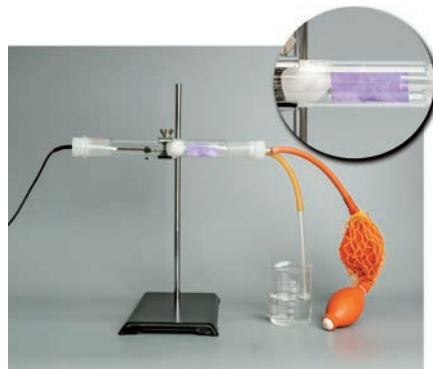
图 7.30 空气氧化乙醇的实验装置
