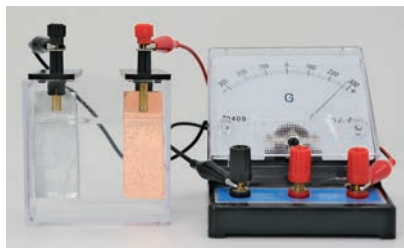
图 5.22 原电池实验装置
