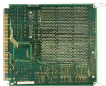
图 5-6 使用酚醛树脂底板制成的集成电路板
