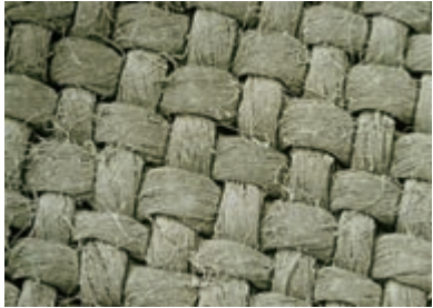
图4-5 显微镜下放大的亚麻布 (可以看到束状亚麻纤维)
