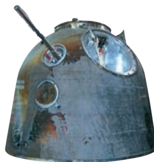
图 5-5 宇宙飞船返回舱烧蚀后的外壳
