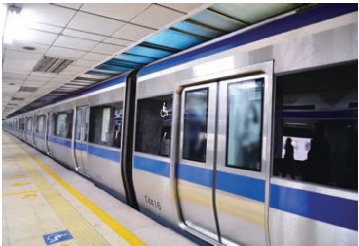
图3-15 用不锈钢制造的地铁列车的车体
