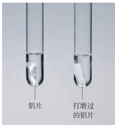
图3-17 将铝片放入NaOH溶液中
