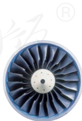
图3-21 喷气式飞机的发动机叶片是由镍、铁、碳和钴组成的镍钴合金制造的，能承受1 100℃的高温
