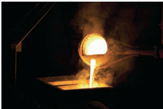
图3-4 钢水注入干燥的模具
