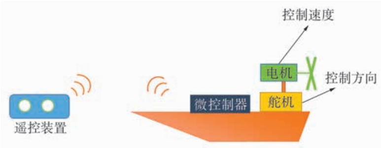
图 3-20 无人船模型设计草图
