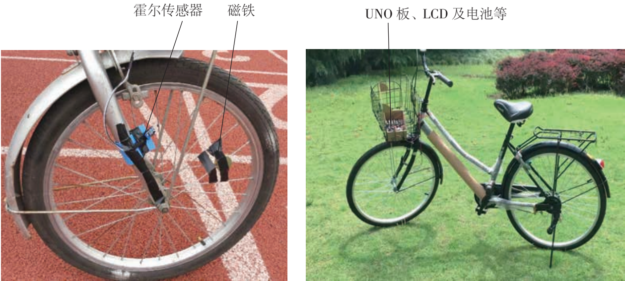
图 2-43 在自行车上安装自行车里程仪
