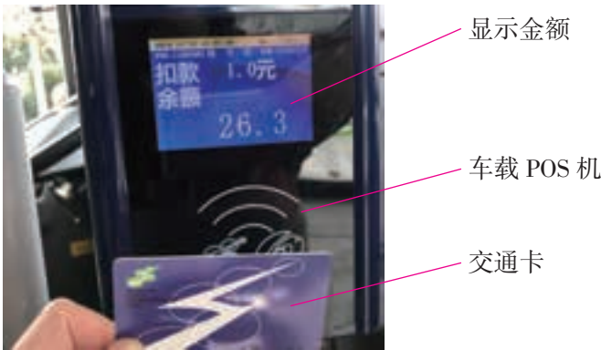
图 1-27 车载 POS 机读写交通卡实现自动收费
