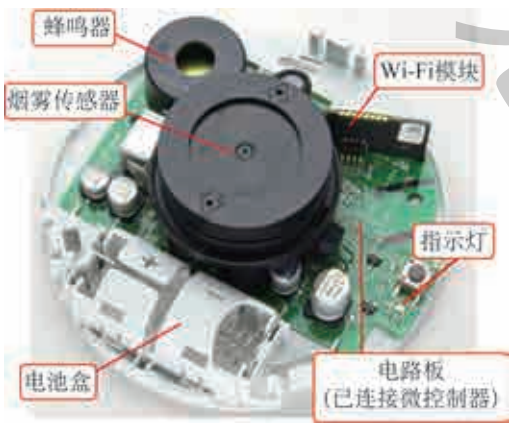
图 1.6 烟雾报警器内部器件
