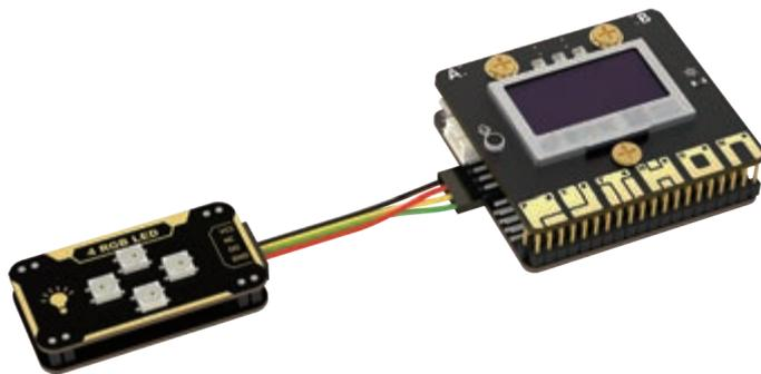
图4.1.10 互联网智能闹钟硬件连接图
