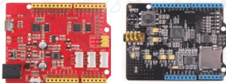
图 1.1.5 Arduino 核心板和扩展板
