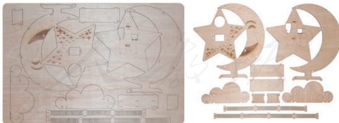
图4.1.4 “互联网智能闹钟”零件实物
