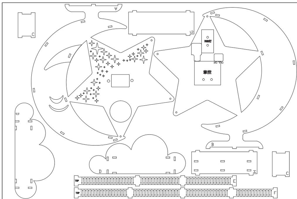
图4.1.3 “互联网智能闹钟”的外形图纸
