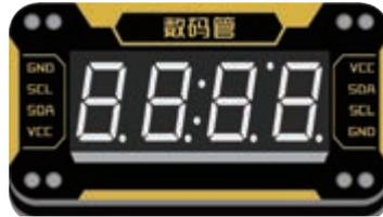
图2.3.6 I<sup>2</sup>C接口的数码管模块
