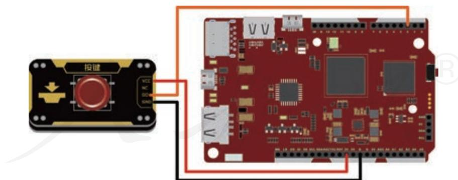
图 2.2.4 V 型板与按键的连接示意
