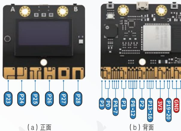
图 2.2.3 B 型板引脚分布图
