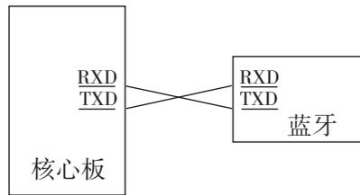
图2.3.4 核心板与蓝牙模块的连接示意
