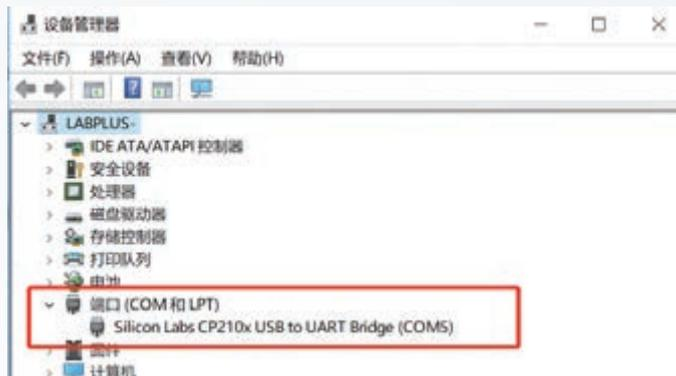
图1.1.9 在计算机设备管理器中查看端口号
