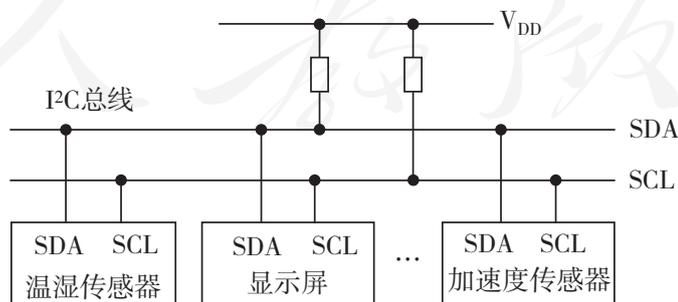
图2.3.5 I<sup>2</sup>C通信示意
