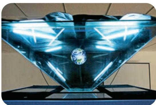
图1.2.25 三维图像悬浮显示装置
