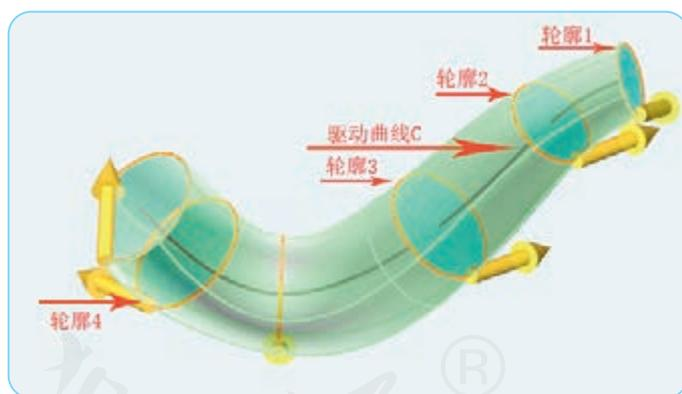
图2.1.18 二维轮廓线经过放样得到三维模型
