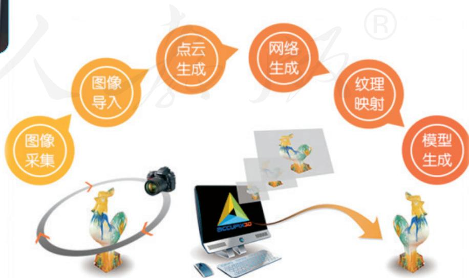
图1.2.8 基于图像的三维重建过程
