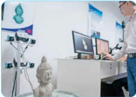
图1.2.9 利用桌面三维扫描仪扫描物品
