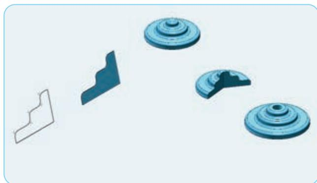
图2.1.16 二维轮廓线经过旋转得到三维模型
