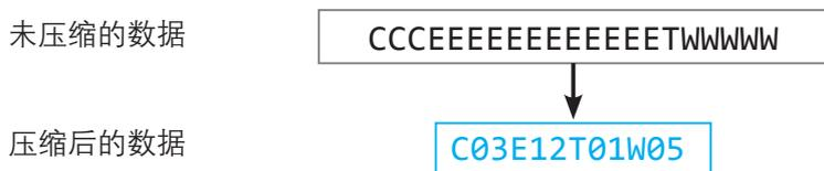
图 1.2.10 简单的无损压缩编码示意图
