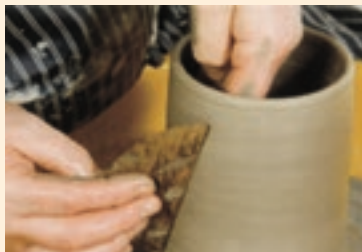
3. 拉薄坯体，然后用型板修正坯体。
