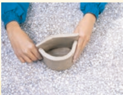
4. 黏合成型，并用刀片将盘边修平。
