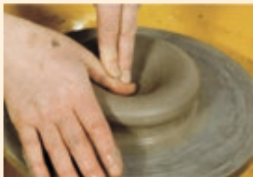
1. 在坯体的顶部中央开洞，双手同时向上将坯体慢慢捧起。
