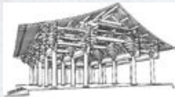
佛光寺东大殿梁架结构示意图
