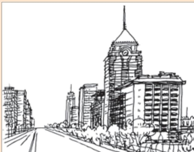
长安街及街两旁的建筑近大远小、近高远低、近宽远窄，最终消失于一点。此图用线条客观真实地表现了这种空间关系。
