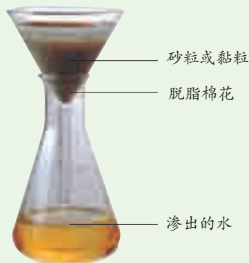
图4-12 土壤的渗水实验
