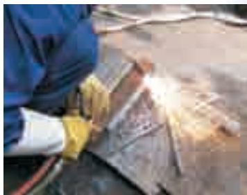
图3-6 乙炔在氧气中燃烧产生的高温火焰可用来切割或焊接金属
