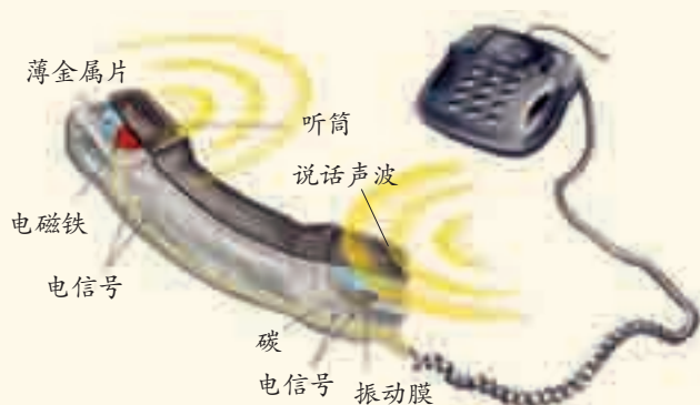
图1-38 电话机的原理
