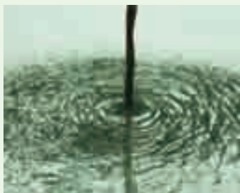
图1-21 直线电流的磁场
