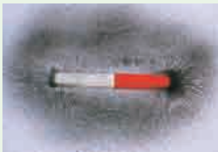
图1-10 条形磁铁的磁场
