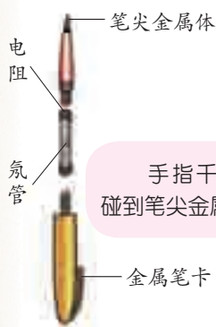
图1-58 测电笔的结构
