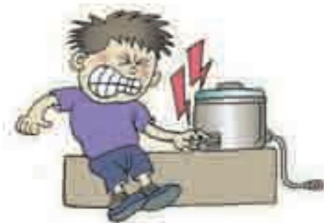
图1-68 无接地线时, 带电的金属外壳会使人触电
