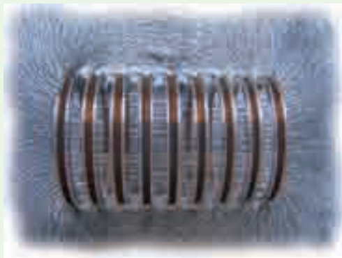
图1-24 通电螺线管的磁场
