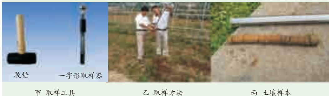
图4-2 用土壤取样器取土壤样本
