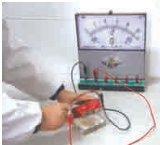
图1-47 磁场中运动的导体
