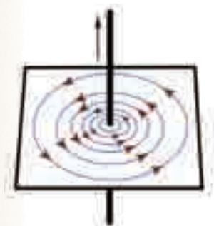
图1-22 通电直导线周围的磁感线分布
