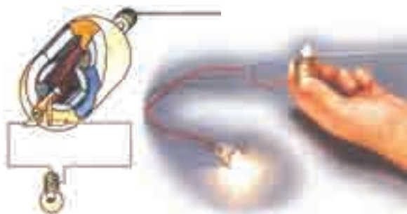
图1-53 旋转电动机的磁体就可以产生电
