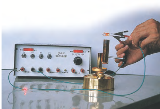
图4-30 烧红的玻璃能导电
