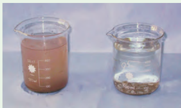
图1-51 泥浆水中加凝聚剂
