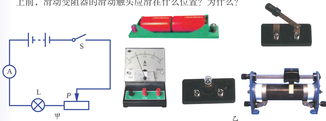
图4-43 电路图与各元件
