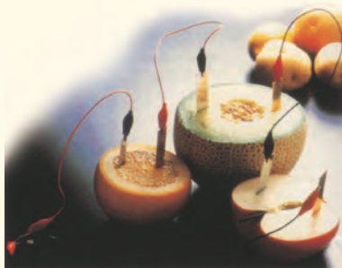
图4-47 水果电池使二极管发光
