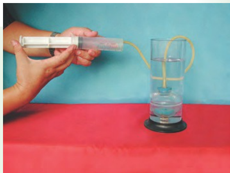
图1-26 潜艇浮沉的模拟实验
