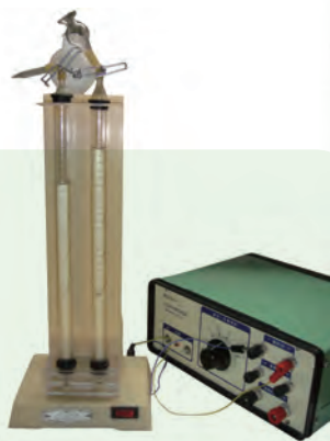
图1-10 电解水的装置
