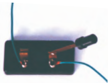
图4-11 开关断开时， 电流不能通过
