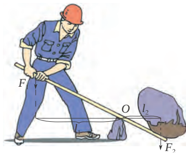
图3-36 用硬棒撬动石头
