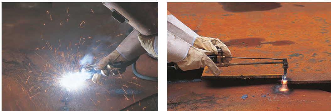
图2-21 用氧炔焰焊接和切割金属
