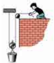
图2-4-4 用滑轮吊起重物
