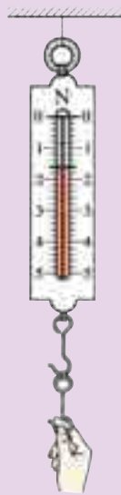
图1-2-2 被拉下秤钩的弹簧测力计
