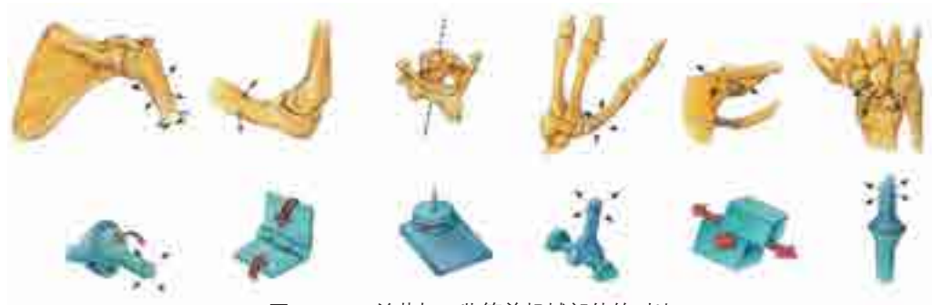
图3-1-10 关节与一些简单机械部件的对比
