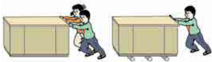
图1-3-12 滑动摩擦与滚动摩擦
