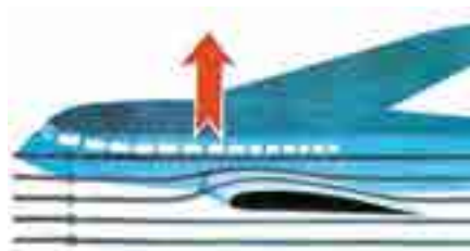
图3-4-3 机翼升力产生示意图
