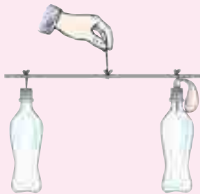
图3-5-9 验证空气浮力实验示意图
