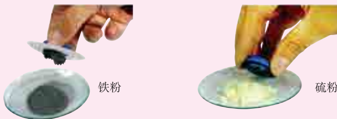
图11-2-2 铁粉、硫粉受磁铁吸引的情况
