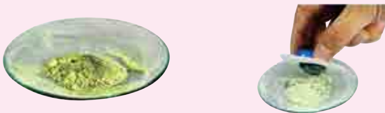
图11-2-3 铁粉和硫粉混合后受磁铁吸引的情况
