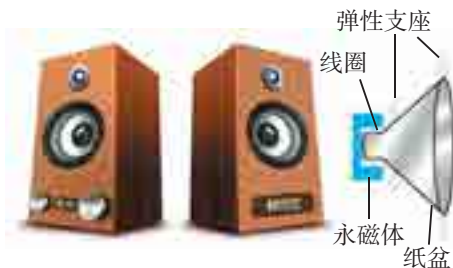
图8-3-7 扬声器结构图
