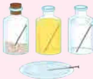
图1-3-4 探究使铁钉发生锈蚀的主要因素
