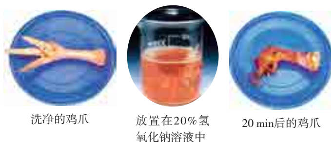
图2-2-6 氢氧化钠的腐蚀性
