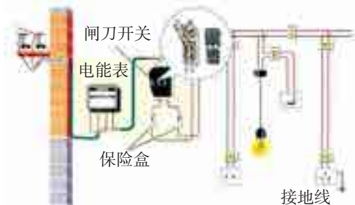
图7-8-2 家庭电路的构成
