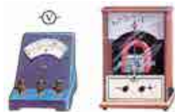
图7-3-2 常见电压表及其电路符号
