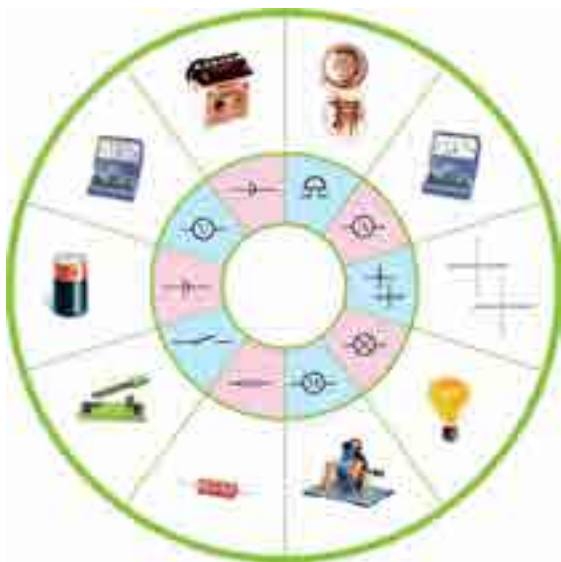
图7-1-5 常见电路元件或电路器件的符号
