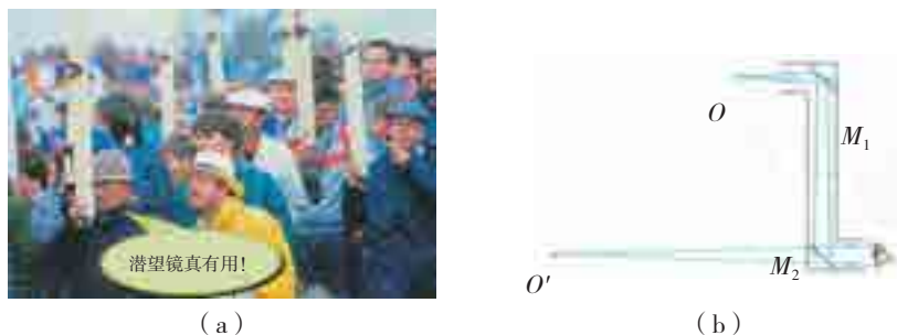
图9-2-7 潜望镜的原理与应用
