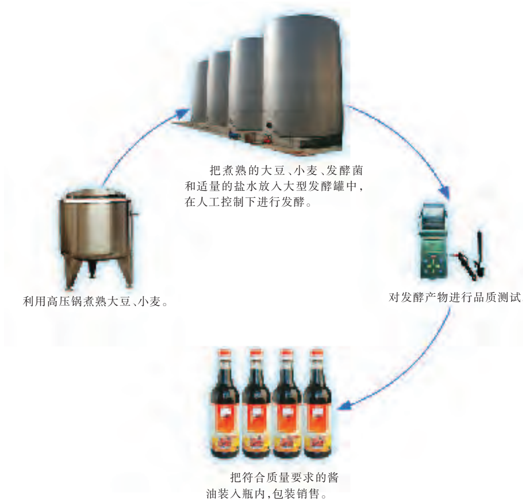
图 23-4 现代的酱油制作过程示意图
