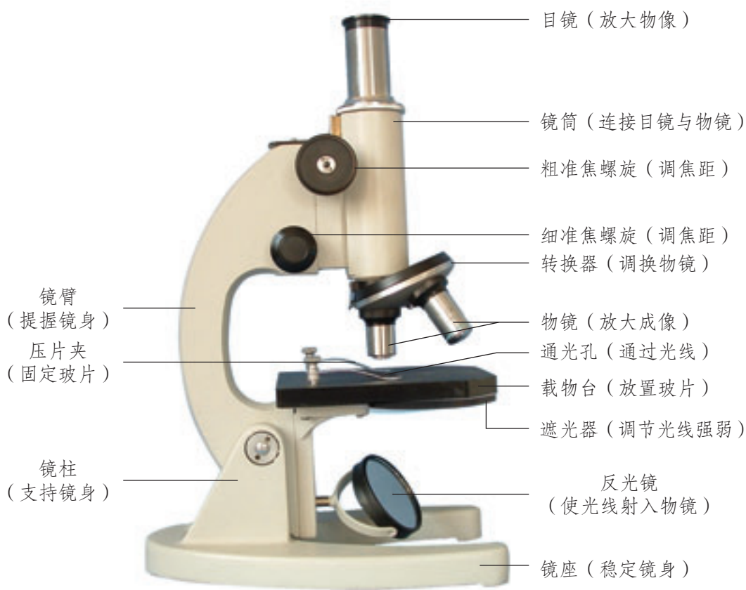
图 2-6 显微镜的结构及各部件用途
