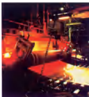
图 2-35 将熔融状态的玻璃轧制成玻璃板
