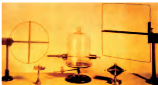
图 17-12 赫兹和电磁波实验装置
