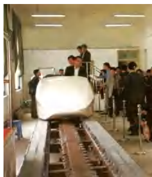
图14-24 载人高温超导磁悬浮试验车“世纪号”
