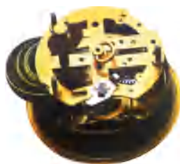
(b) 发条带动钟表的齿轮和指针转动
