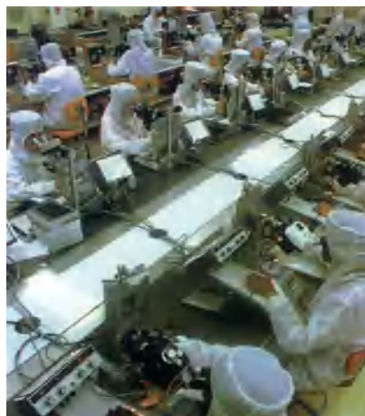
图 13-10 集成电路生产及测试的每个工作流程都必须无尘和干燥的环境下进行
