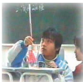
(b) 在玻璃管一端系一个装有红色墨水的小气球，可以探究水内部压强的大小
