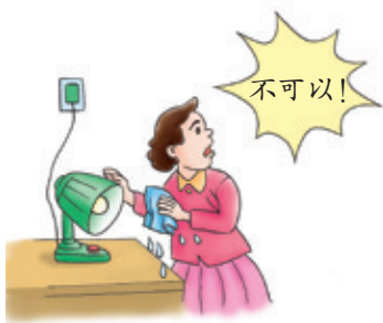
图 9-3-2 不能用湿手摸或用湿布擦与电源相连的灯具等电器，以防触电
