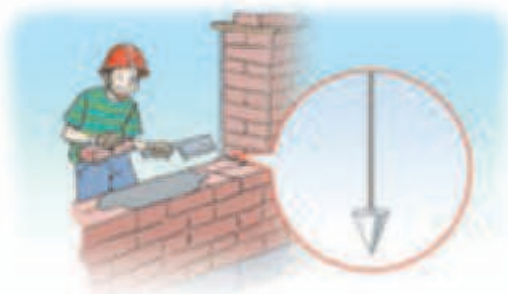
图7.3-4 利用铅垂线确定竖直方向
