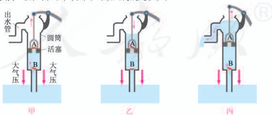
图9.3-8 活塞式抽水机工作示意图
