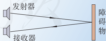
图1.4-3 超声波测距原理
