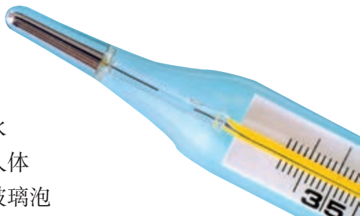
图3.1-4 体温计 (细管处水银柱断开)
