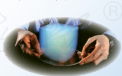
图6.4-5 气凝胶是当今世界上密度最小的固体。这种新材料具有隔热、耐高温等性能，有多种用途。
