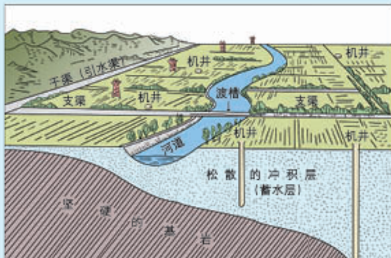
华北平原渠灌、井灌结合示意图
