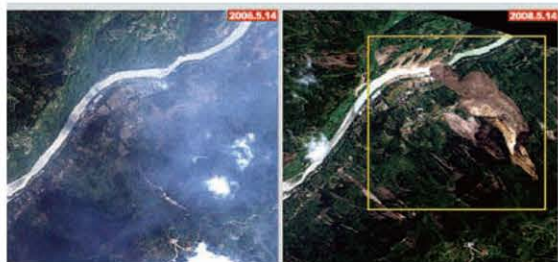
a 卫星影像对比图 上图为经过汶川大地震，北川部分地区地震前、后对比图。图中黄框部分标示的就是地震后山体发生坍塌的部分。
