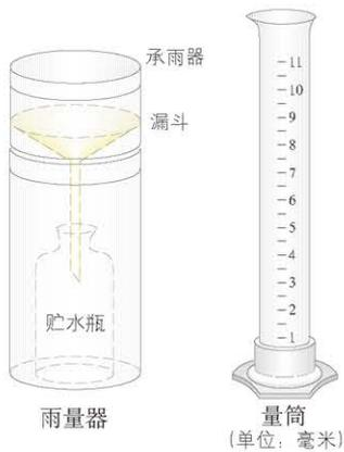
**降水量的测量** 用雨量器和量筒测算降水量。将雨量器中贮水瓶所接纳的全部雨水倒入量筒中，根据量筒上的刻度，确定水量是多少毫米。如果是降雪或冰雹，则需要将它们融化成水后再测量。
