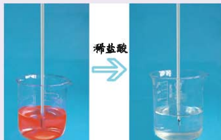
图7-12 测定酸和碱反应前后温度的变化
