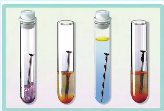
图8-8 铁钉锈蚀实验
