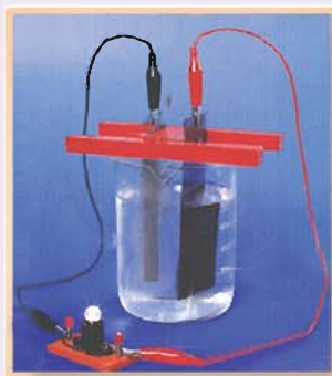
图9-11 化学能转化为电能的实验装置
