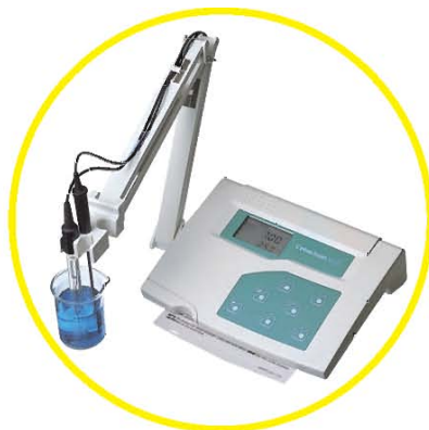
图7-4 用酸度计测定溶液的pH
