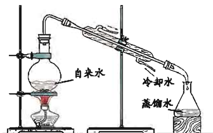
图2-21 实验室制取蒸馏水的装置
