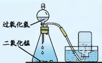
图2-15 分解过氧化氢制取氧气的装置
