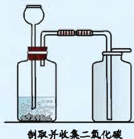
图4-17 实验室制取二氧化碳的一种装置
