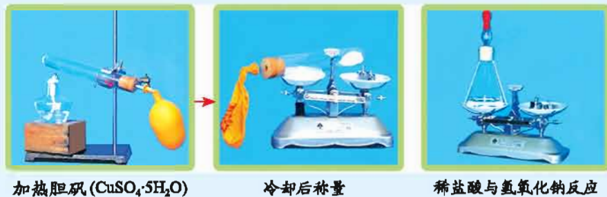
图5-4 探究化学变化中质量关系的实验
