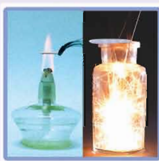
图2-9 铁丝在空气中加热和氧气中燃烧
