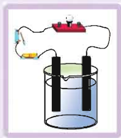
图6-6 溶液导电装置
