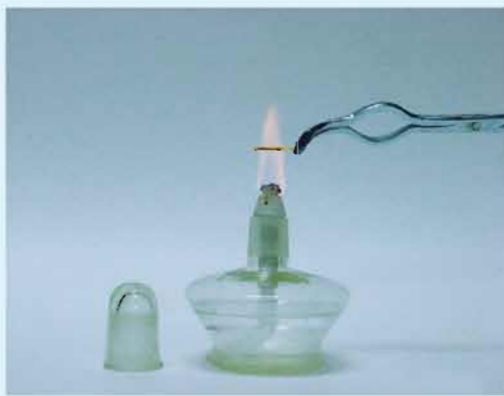
图1-16 比较酒精灯内外焰温度的实验
