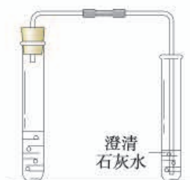
图 11-4 碳酸钠与盐酸反应的装置
